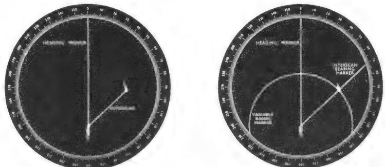
Bild 3. Interscan-Anzeige; a) zur Ermittlung von Entfernung und Peilung eines Zieles, b) zur Peilung in Verbindung mit dem variablen Entfernungsmesskreis
